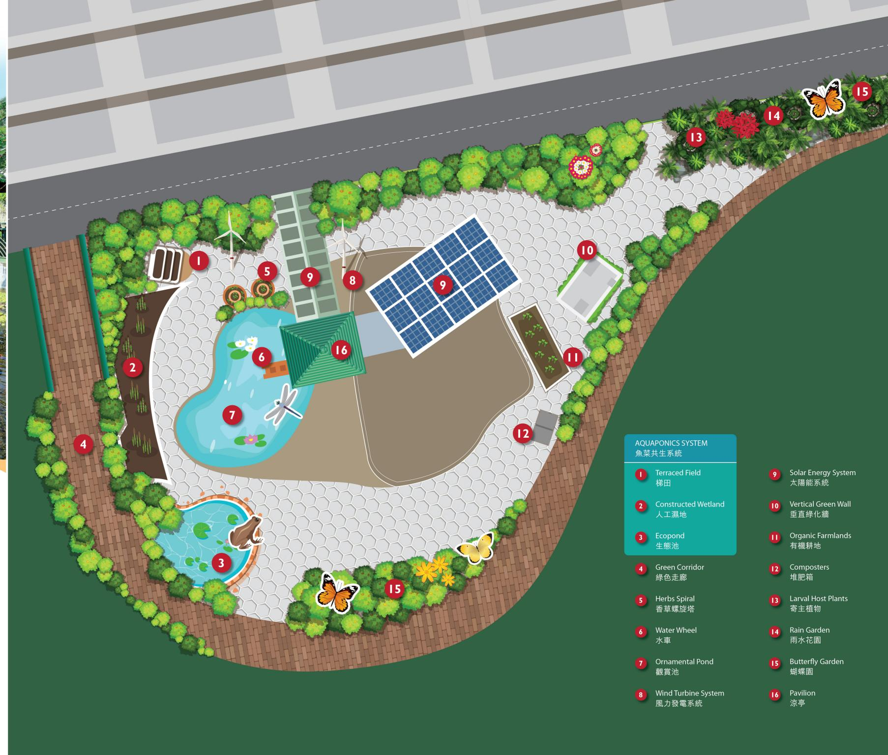
太陽是地球上最主要的能量來源。透過太陽能光伏板, 我們可把陽光轉換成電能。在生態園內分別安裝了三款 不同的太陽能光伏板,它們包括:單晶矽光伏板、 多晶矽光伏板及薄膜光伏板。單晶矽太陽能電池由 完整的矽晶體切片而成,普遍形狀為缺少四角的正 組成。薄膜光伏板在玻璃、金屬或塑膠物料之上沉積 一層非晶矽或其他光伏材料的薄膜。
