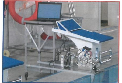
圖一 拉線式速度監控設備的外形及其架設
