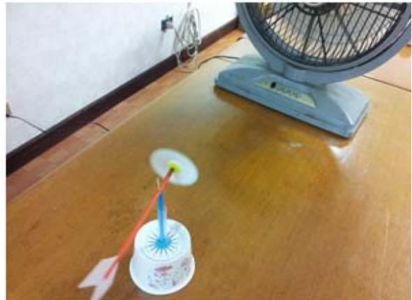
圖七：風車型風向儀指向風來的方向
